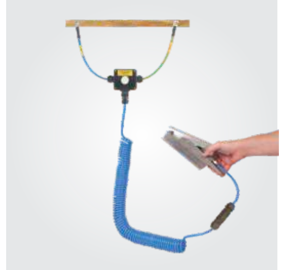
Bond-Rite CLAMP 配有双导体电缆、接线盒、夹钳存储栓和接地导线。电路监测板和电池安装在夹钳内。不提供接地母线。
