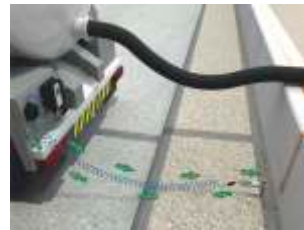
接地回路持续监控检查
