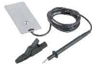
扩展组件由鳄鱼夹、测试探头和不锈钢板组成。对于没有足够大的表面连接到 OhmGuard 夹钳的测试设备是理想的选择。执行测试的人只需将 OhmGuard 的夹钳触点连接到板上, 然后将探头或鳄鱼夹连接到测试设备上。
