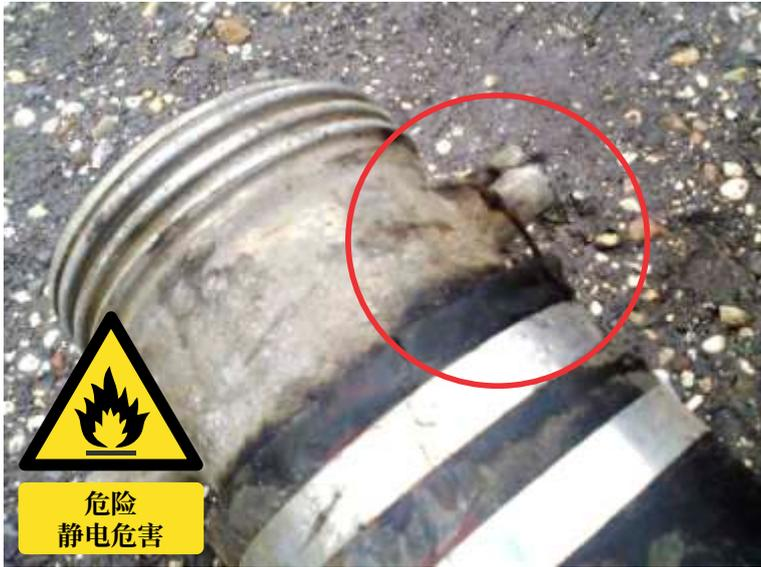
增强软管抗排出和吸入压力的金属螺旋线，通常被用于在软管的端部接头或连接件之间提供电气连接。重要的是要确保电线（如图所示）不会断裂，因为这样会导致隔离导体的存在，这些导体有可能在材料转移操作中反复释放静电火花。
