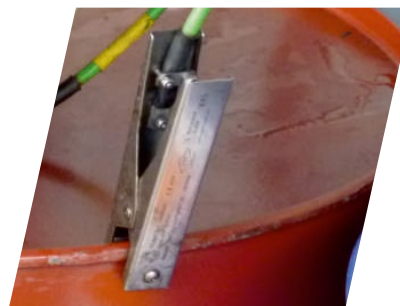
静电接地夹钳必须能够穿透涂层、产品沉积物和铁锈，以确保与过程设备操作过程中良好的电气连接。操作人员应接受培训来回拨动夹具，使其穿透涂层，从而看到与基底金属之间接触
