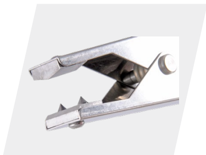
碳化钨合金齿用于穿透由铁锈、涂层和产品沉积层产生的电阻抗。
