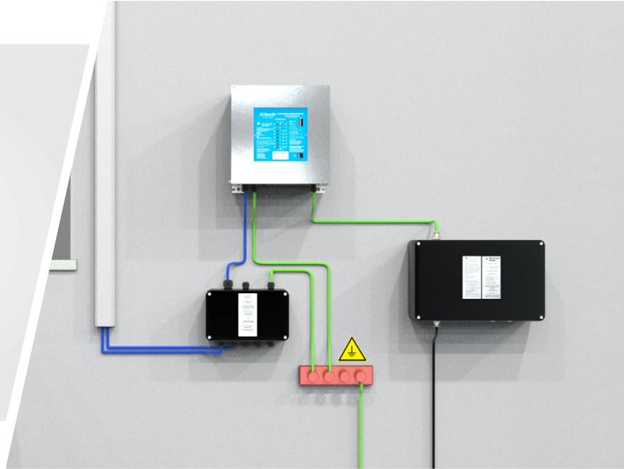
为了在多桶装载站、混合站、复合型中型散装容器装载站和轨道车装载龙门架等地点对多个设备进行接地和监控，需要大量常规的静电接地系统来防止易燃静电火花。除了易燃液体和气体操作之外，通常包括互连管道、流化床干燥机、料斗和微粉磨机的粉末加工设备也需要多个接地系统。通过 Earth-Rite MULTIPOINT II，可以使用单个静电接地系统同时对潜在的隔离设备的多达八个独立部件进行接地监控。
