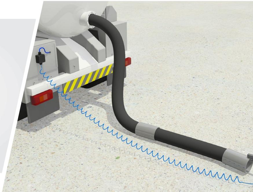
OhmGuard® 电气连续性测试仪用于在转移易燃或可燃产品之前测试在吸污槽车、公路槽车和厂房设备上使用的软管。它也可以作为一种有效的方法来检查与已验证的接地点相关的静电连接组件和导体。
