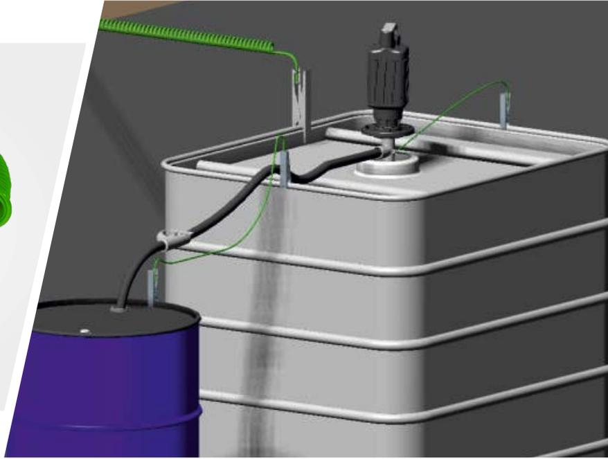
与经验证的实际接地点（壁挂式的接地牌）之间实现低电阻连接，才能让设备接地。该过程使用的其他设备可以和接地设备绑定
