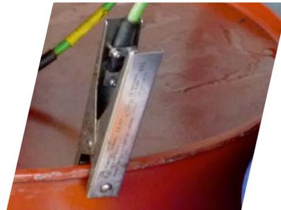
静电接地夹钳必须能够穿透涂层、产品沉积物和铁锈，以确保与过程设备操作过程中良好的电气连接。操作人员应接受培训来回拨动夹具，使其穿透涂层，从而看到与基底金属之间接触
